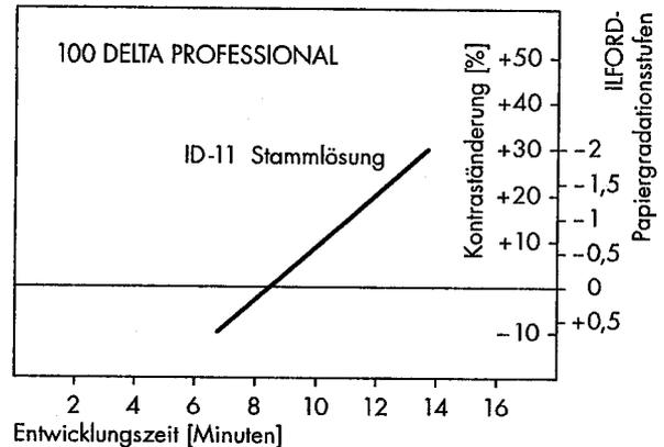
So würden Sie z. B. bei Entwicklung des 100 DELTA PROFESSIONAL in ILFOTEC HC (Verdünnung 1+31) statt der normalen Entwicklungszeit von 6 Minuten im ersten Diagramm als neue Entwicklungszeit knapp 7 Minuten dort ablesen, wo die Entwicklungszeit-Kontrast-Kurve die Linie für eine Änderung der Papiergradation um -0,5 schneidet. Alternativ können Sie ILFORD-MULTIGRADE-Papier verwenden, mit dem sich auch halbe Gradationsstufen erzielen lassen.
