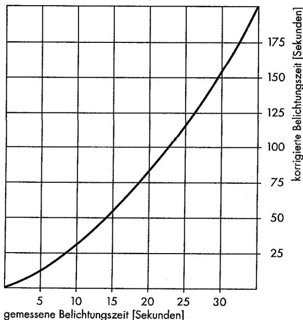
Der Empfindlichkeitsverlust durch den Schwarzschildeffekt kann bei allen Filmen von einer Charge zur anderen etwas schwanken. Diese Unterschiede werden bei sehr langen Belichtungszeiten besonders deutlich. Deshalb sollten Sie bei Zeiten, die den Bereich des Diagramms überschreiten, eigene Tests mit Filmen derselben Emulsionsnummer durchführen, wie Sie sie für die eigentlichen Aufnahmen verwenden.
