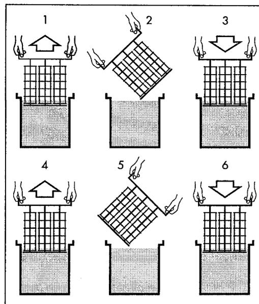
Heben Sie den Rahmen nach Ablauf jeder weiteren Minute aus dem Bad, kippen Sie ihn zur Seite, tauchen Sie ihn wieder ein und wiederholen Sie das noch zweimal, wobei Sie jeweils die Kipprichtung wechseln. Stoßen Sie den Rahmen nach dem dreimaligen Herausziehen und Eintauchen an der Tankkante auf.
