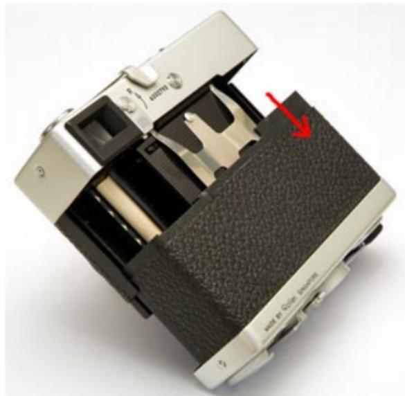
Die Rollei 35, 35T und 35S benötigen für den Belichtungsmesser eine PX-625 Batterie mit einer Spannung von 1,35 Volt. Aktuell werden Quecksilberbatterien mit 1,35 Volt Spannung nicht mehr angeboten und man ist auf verschiedene Ersatztypen angewiesen. Die einfachste Variante ist eine Batterie mit der Bezeichnung „Wein Cell“. Diese Zink-Luft-Batterie wird vor dem Gebrauch aktiviert und gibt die richtige Spannung für den Belichtungsmesser ab. Es sind auch Adaptern
