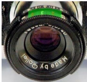
Auf dem Objektiv sind die sog. Schnappschussentfernungen (2 Meter und 6 Meter) rot gekennzeichnet. Bereits bei einer mittleren Blende (5,6 bis 8) ergeben sich daraus ausreichende Schärfenbereiche für Personen-, Gruppen- und Landschaftsaufnahmen (*Bild links*).
