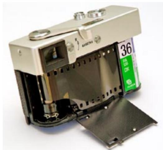
Nachdem der Film in die Auffangspule eingehängt ist, sollte darauf geachtet werden, dass die Perforation in der Antriebswelle zu liegen kommt. Dann klappt man die Filmdruckplatte wieder nach oben. Wenn man nicht so sehr mit dem Filmmaterial sparen muss, kann man auch einmal aufziehen um den Filmtransport zu kontrollieren. Passt der Filmtransport, kann die Rückwand angesetzt und geschlossen werden. Die Verriegelung muss manuell in die „geschlossen“ Position gebracht werden.
