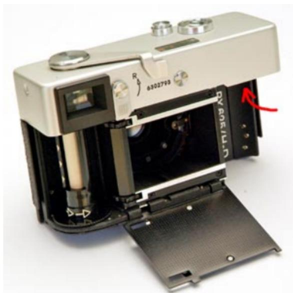
Nachdem die Rückwand abgenommen (und eine Batterie eingelegt) ist, kann ein Film eingelegt werden. In die Rollei 35 Modelle passen alle handelsüblichen und selbst konfektionierten 35mm Filme. Eine DX-Codierung der Filmpatrone ist nicht erforderlich, die Filmempfindlichkeit muss in jedem Fall von Hand eingestellt werden.
