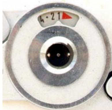
In der Rollei 35 können Filme mit Empfindlichkeiten zwischen ISO 25 und 1600 verwendet werden. Die Filmempfindlichkeit wird manuell am Einstellrad für die Blende eingestellt. Die Belichtungsmessung erfolgt bei allen Rollei 35 Kameras durch eine Messzelle im Kameragehäuse und nicht durch das Objektiv. Daher bleiben am Objektiv angebrachte Filter und deren Korrekturfaktoren bei der Belichtungsmessung unberücksichtigt.
